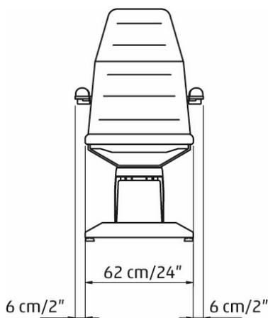
Le fauteuil d'esthétique Lemi 3 est équipé d'une pédale pour le réglage en hauteur. Le dossier se règle manuellement à l'aide d'un vérin à gaz. Le repose-jambes et l'assise sont réglés manuellement.
